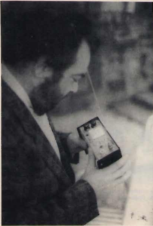
Il "M.I.C." è in grado di rivelare e misurare l'intensità del campo e.m. presente in un dato punto dello spazio.
